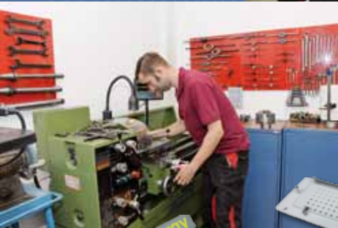
In der Feinmechanischen Werkstatt dreht Henry Bürth Zubehör für eine Zentrifuge.
