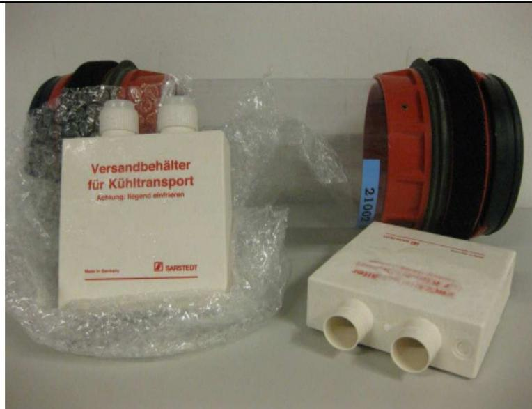
EDTA-Röhrchen in den Kühlbehälter legen, Kühlbehälter verschließen und den Kühlbehälter in Luftpolsterfolie verpacken → versandfertig
