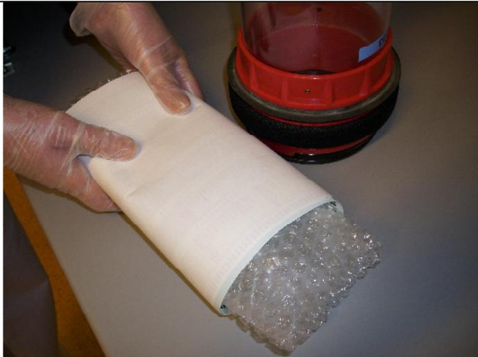
Die Rohrpostkartusche muss oben und unten mit Luftpolsterfolie ausgestopft werden.
